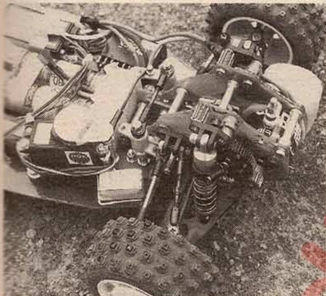
↑フロントにオーバーハングしてマウントしているモーター。ギャボックスは自作。
