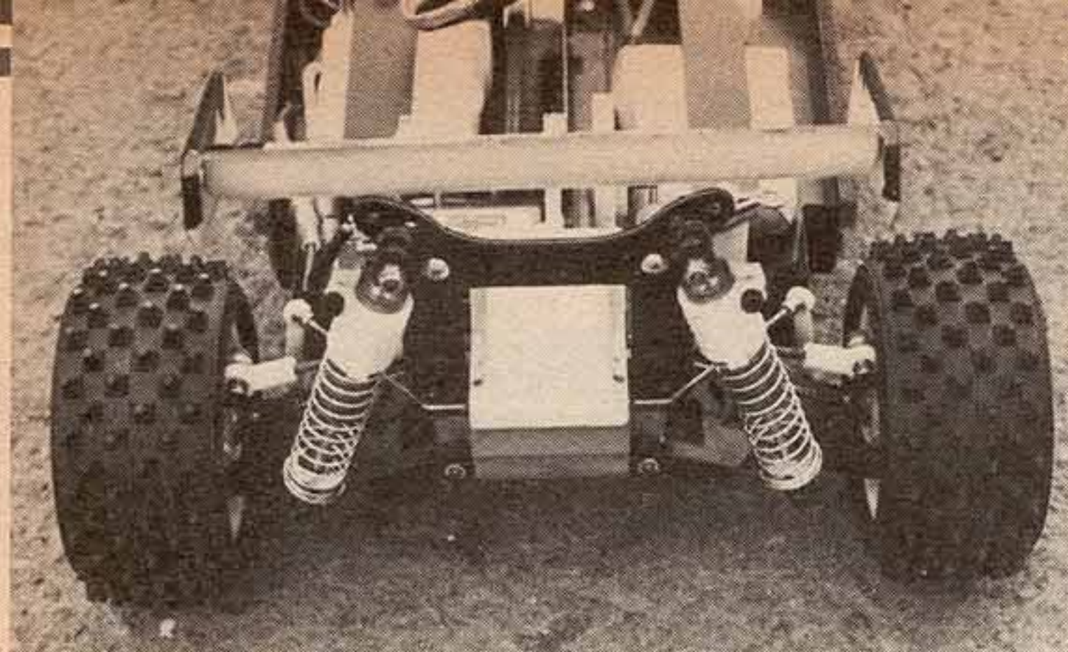
↑ダンパー・ステアはオフショーンのグラフィイト製に交換した。
